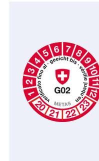
La marcatura di verificaione adiacente viene utilizzata per gli strumenti di misura per i quali il periodo di validità della verificaione è inferiore a quattro anni. La validità è indicata mediante marcature con fori nel mese e nell'anno di scadenza. La verificaione è stata eseguita dal laboratorio di verificaione G02. Questa marcatura di verificaione viene utilizzata per i dispositivi di conversione del volume.
