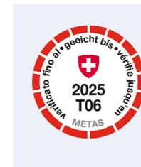
La marcatura di verificaione adiacente viene utilizzata per gli strumenti di misura per i quali il periodo di validità della verificaione è superiore a quattro anni. La verificaione nell'esempio è valida fino al 31 dicembre 2025. La verificaione è stata eseguita dal laboratorio di verificaione T06.
