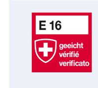
I trasformatori di misura recano la marcatura di verificaione rettangolare. La verificaione è stata eseguita dal laboratorio di verificaione con il numero E16.
