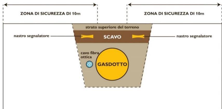
Lo schema qui sopra indica una sezione del gasdotto e le distanze di sicurezza da osservare in caso di qualsiasi tipo d'intervento. Per lavori quali opere di genio civile, deposito di materiale, lavori di rivestimento e lavori di costruzione di ogni genere, da effettuare all'interno della zona di sicurezza, è necessaria l'autorizzazione da parte delle AIL SA.
